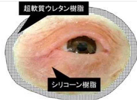
図2 シリコン樹脂/超軟質ウレタン樹脂複成型
