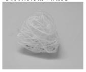
3D プリンターを用いて補填材骨格のモデルを製作したが、 3次元網目構造に似た骨格は製作できたものの、動物本来の形状 を模倣することがまだ困難であることがわかった.
