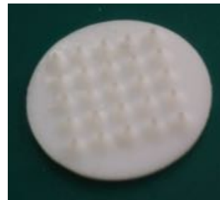
振動板の3Dプリンタによる形成例
