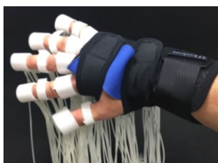
図 8 手に触覚提示を行うデバイス
