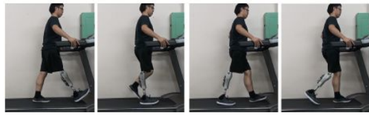
図8 能動義足状態での歩行評価実験
