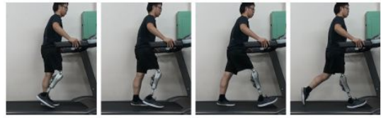
図8 能動義足状態での歩行評価実験
