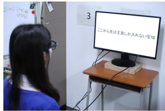
図3 横文字を読む際の眼電位測定実験の様子
