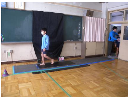
図1a 歩行動作中の足底圧計測
