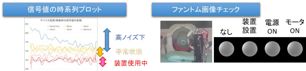
図4 . fMRI スキャン中の装置稼働による画像への影響の検討
