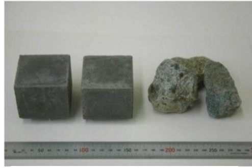
図 1 安定化構造体と単粒度碎石
