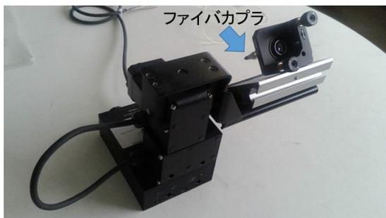
図5 パンチルトに搭載されたファイバカプラ
