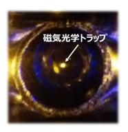
図 8 準安定状態 Eu 原子の 磁気光学トラップ
