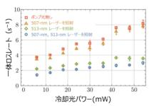
図9 一体ロスレートのポンプ光及び、 冷却光パワー依存性
