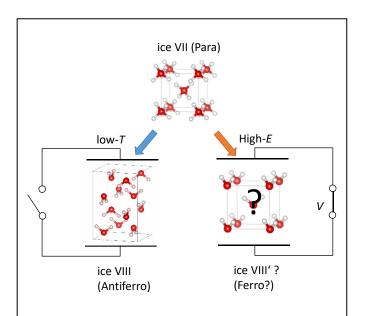
図2. 高圧氷(ice VII)は低温で秩序相の氷 VIII 相に相転移する(左下). 本研究では電場によっての新たな秩序構造(ice VIII')を誘起する(右下).
