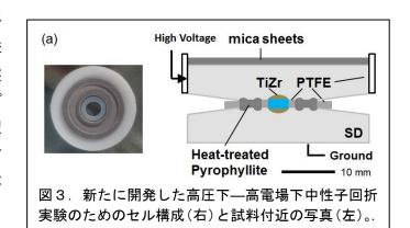
びテフロン性のガスケットでアンビル間を絶縁した。電極のついていない側のアンビルは 接地させて、放電時には高圧電源が落ちるようにインターロックをかけた。また、セルか らの寄生散乱を避けるため、中性子を吸収するガドリニウム酸化物を塗布したフィルムを 用いた小型のラジアルコリメーターも新たに開発した。
