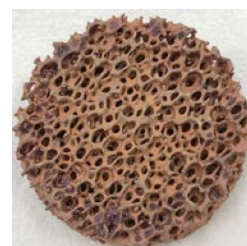
図4 蒸発乾固法で作製した 10mol%-Fe ドープセリア担持発泡体反応デバイス
