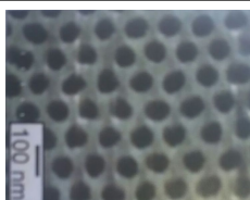
図9: アルミニウム基板上に形成されたマクロポーラスアルミナ皮膜のSEM像。
