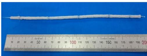
図 3 試作した極細カテーテルアクチュエータ
