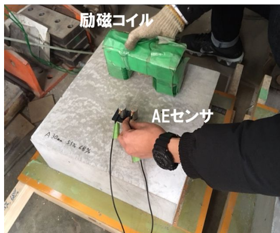
図3 硬化コンクリート試験体計測概要
