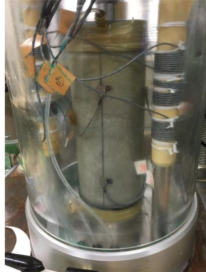
図1 圧力セル内の円柱供試体と側面に設置した AE センサーの例
