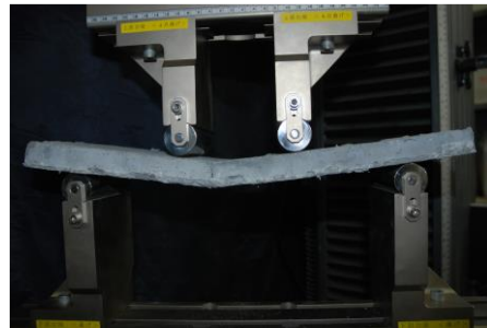
図6 繊維混入試験体の曲げ試験破壊状況
