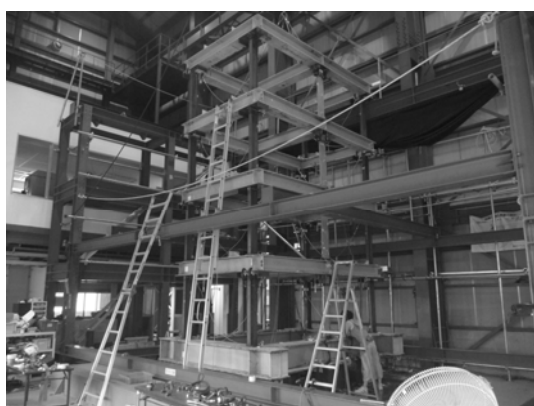
図1 免震+制震試験体概観
