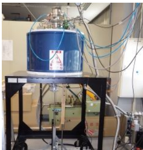
図 1 超電導マグネット内に設置されたエレクトロマイグレーション実験装置
