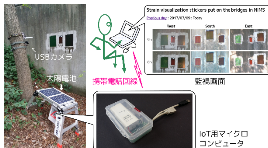
図7 コンクリート橋壁面での実証実験
