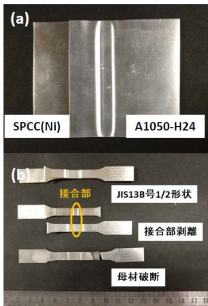
図 2(a) 接合板の外観写真、(b)引張試験片形状と試験後の試験片形状。
