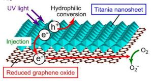
ートの光触媒作用によりポリマー層が酸化分解して除去されるとともに酸化グラフェンが還元され、酸化チタンナノシート単層膜と還元型酸化グラフェン単層膜からなるヘテロ構造膜が構築できた。
