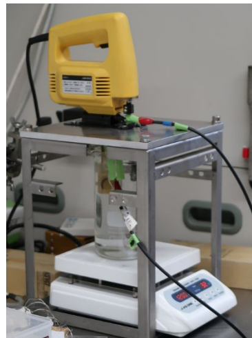
図1 高速縦揺動が可能な電気分解セットアップ
