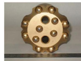
図1 衝撃貫入試験の概略図とボタンビットの写真。
