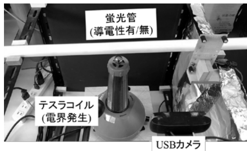
図2 電界による発光実験装置の写真
