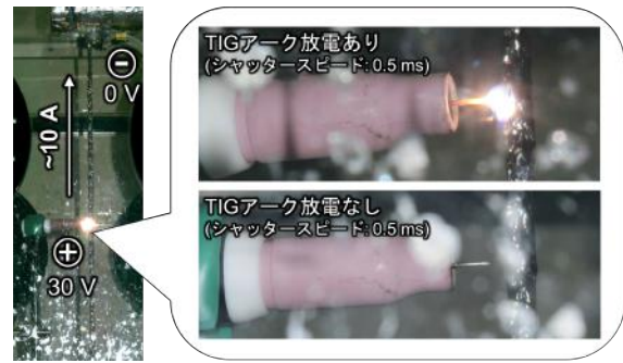
図5 アルゴン雰囲気中におけるUアロイ78噴流へのアルゴンTIGアーク放電実験。
