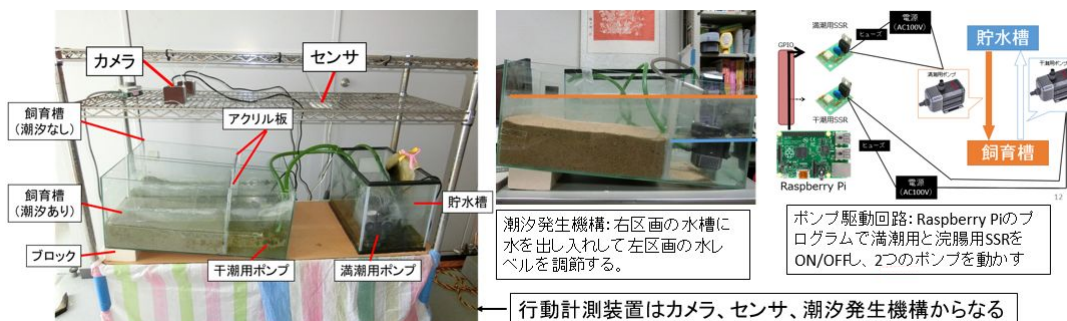
図3 装置の全体構成と潮汐発生機構
