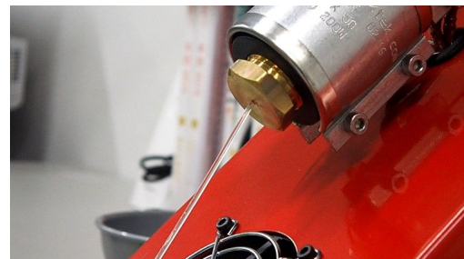
一軸押出機を用いた PLA フィラメントの作製
