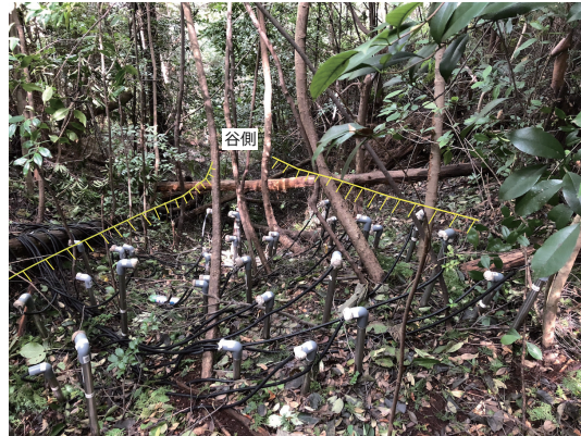
図 1 超音波水分水位計測による高密度自然斜面計測。斜面の傾斜は約 30 度。
