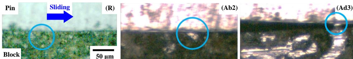
図7 ベースパッド材 (R)、アブレイブ系パッド材 (Ab2)、凝着系パッド材 (Ad3) における in situ 観察結果
