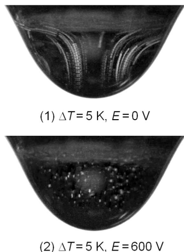
図5 液滴内の温度差表面張力流(上)と600 Vの電圧を印加したことによる対流の抑制(下): 白い線または点は1秒間のトレーサ粒子の軌跡である
