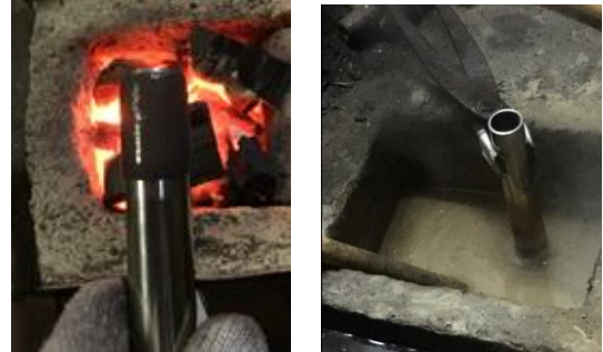
図9 熱処理、炉での加熱
