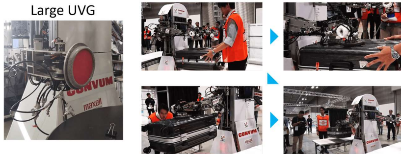
(a) 大型 UVG を用いた凹凸面を有するスーツケースの把持搬送
