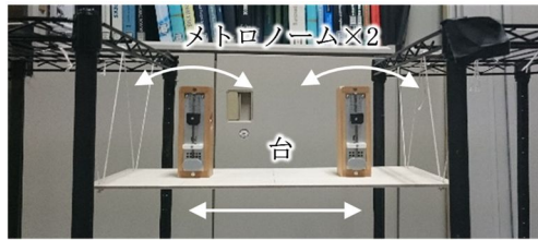
図1 製作した同期実験用の装置：台が水平方向に動くようになっており、一方のメトロノームの揺れが台を介してもう一方へ伝わり、同期（2つの針の振動リズムが揃う）が起こる。
