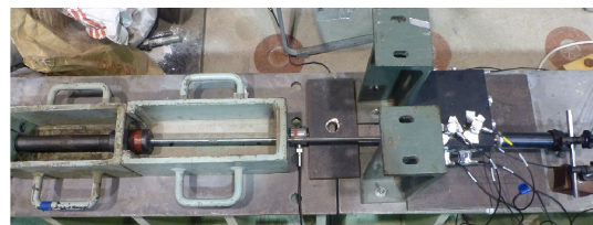
写真-1: 引抜き試験の写真
