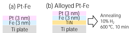
図4 (a)Pt-Fe および(b)Alloyed Pt-Fe 触媒電極の構造および熱処理条件
