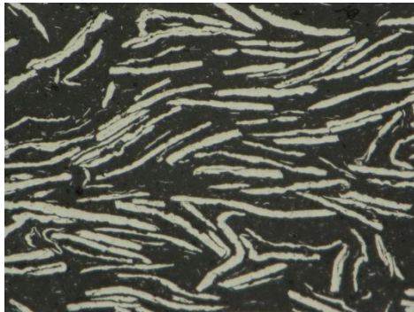
図 9 メタセラ材料の組織写真例
