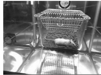
図 1 光照射ケージ。 全面金属反射材張り。空調設備もついている。
