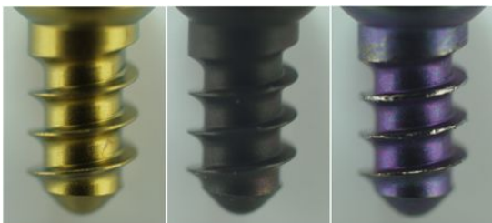
図 4. スクリューの顕微鏡像 (左から未処理チタン、熱処理 Ti、スラリー処理 Ti)
