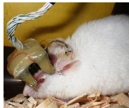
図1 3次元顎運動・筋活動計測システム
