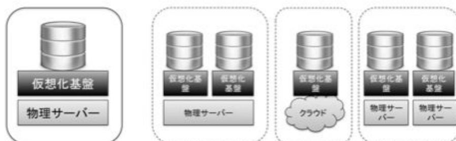
図1 本研究で構築したモデル(実線)は、仮想化技術を応用して構築することで、アーキテクチャが異なるサーバー上(破線)でも動作が可能となる設計となる。クラウド構成や、クラウド上、または分散システムへのデプロイを可能とする。
