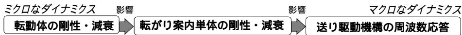
図2 転動体の剛性・減衰と送り駆動機構の周波数応答の関係
