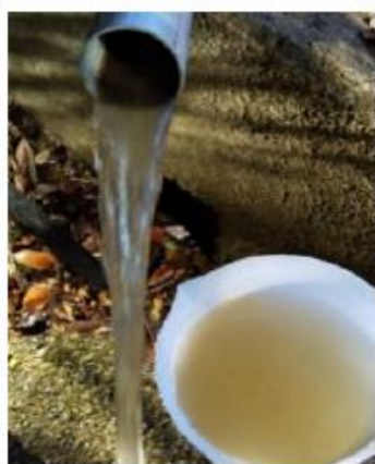
図2 左：漏水の濁り 右：貯水位と漏水量の関係（松井ら 5) から引用，加筆）
