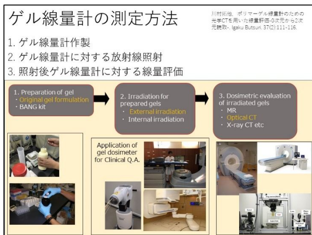
図 1. ゲル線量計の測定方法と使用装置
