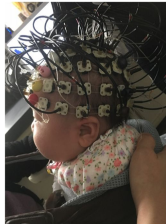
図1. 開発した新生児用全頭型プローブ・ホルダ。装着例。
