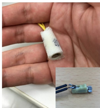
図 2. 感覚刺激に用いた小型振動モータ。
