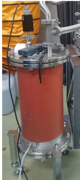
図2 試料蒸気生成用タンク
