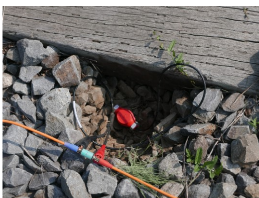
図4 バラスト下に設置された受振点
