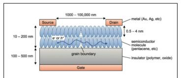
図 1 有機トランジスタの模式図(側面図). 楕円 1 つがペンタセン(C<sub>22</sub>H<sub>14</sub>)分子 1 個に相当する.
