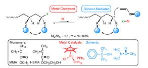
一方、側鎖に水酸基を有するメタクリル酸 2-ヒドロキシエチル(HEMA)の重合では、 ジメチルアセトアミド(DMA)のような非プ ロトン性極性溶媒中で、シンジオタクチシチ ーの高いポリマーが得られ、一方、フルオロ アルコール中では、アタクチックに近い立体 規則性の低いポリマーが得られた。これは、 モノマー側鎖水酸基が、これらの溶媒と特殊 な水素結合を形成するためである。
